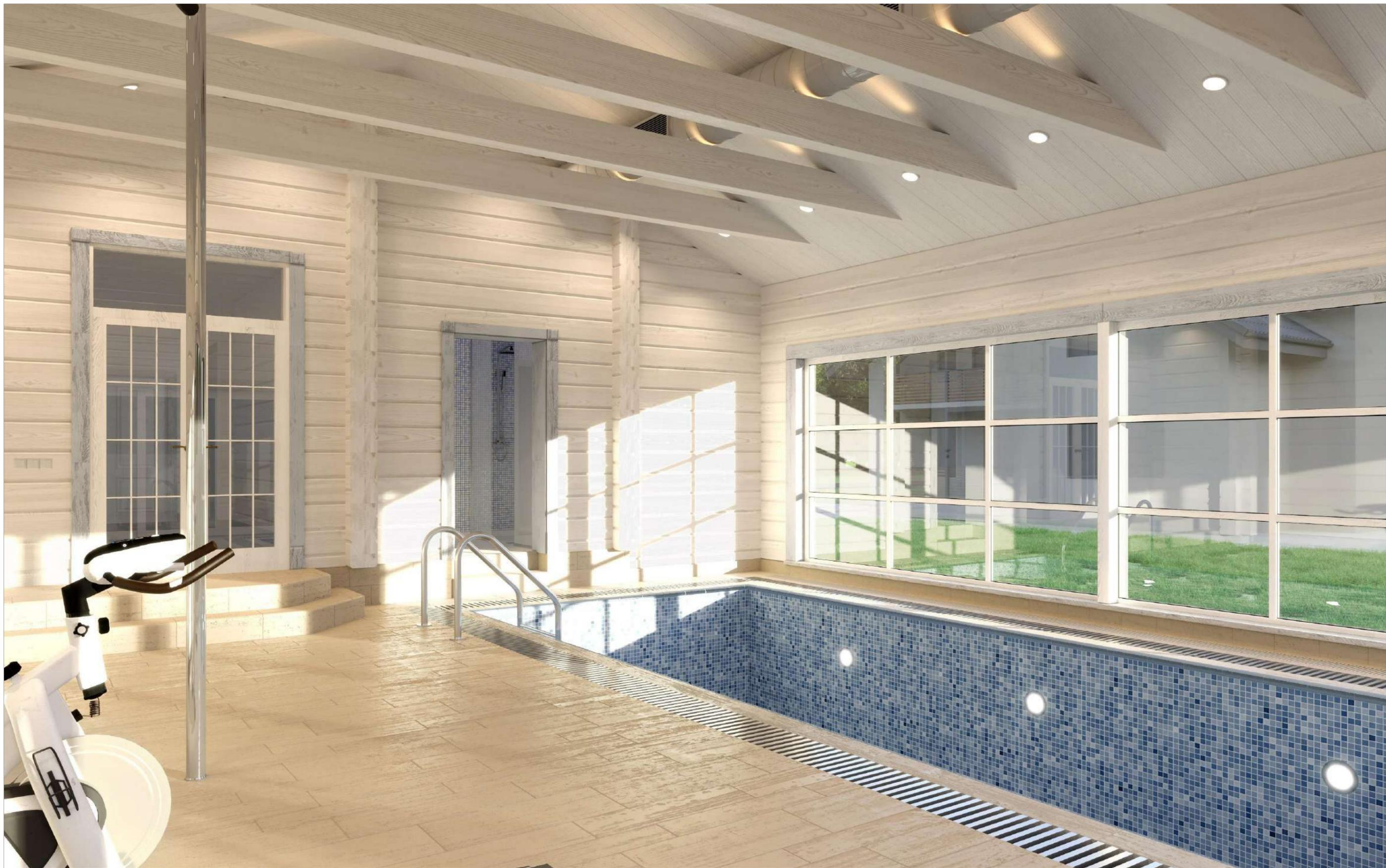
Чаша бассейна выполнены из мика мозаики на выбор заказчика по образцам. По периметру организован слив/перелив из из решетки. Вдоль панорамного окна и панорамной двери установлены конвекторы с системой водоудаления. В помещении дополнительно встроен тренажерный шест с усиленным креплением. Глубина бассейна от 1,4м до 1,8. Напольное покрытие из нескользящей песчаной плитки. Бассейн оснащен освещением, а так же противотокм для создания змитации течения.
